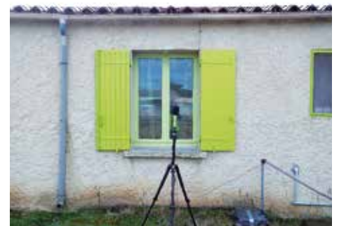
Prise de mesures acoustiques sur site
