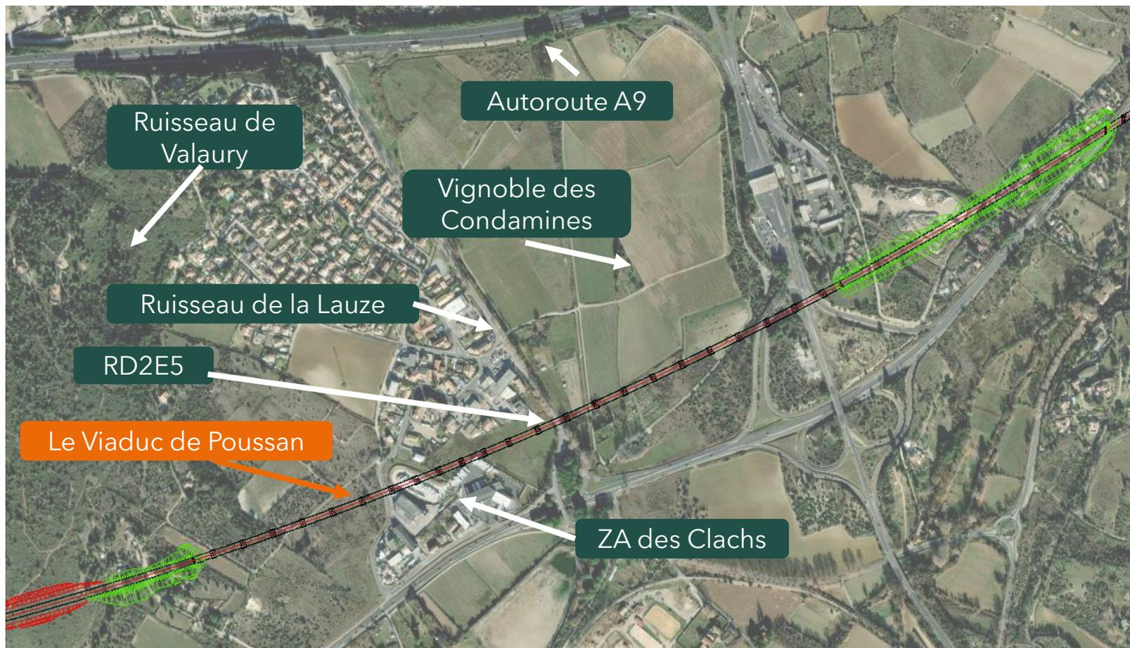
L'aménagement d'un viaduc à la place de remblais massifs dans la plaine de Poussan permet de limiter l'emprise au sol de la Ligne Nouvelle et de préserver les continuités paysagères en conservant les transparences visuelles sous l'ouvrage.
