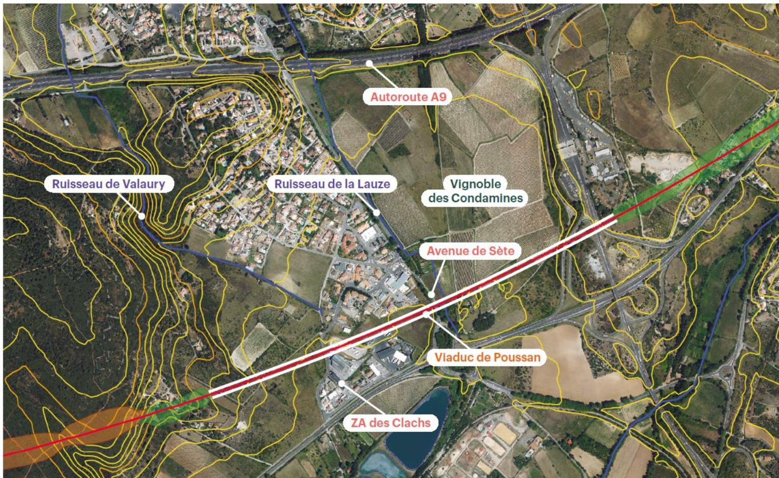
L'aménagement d'un viaduc à la place de remblais massifs dans la plaine de Poussan permet de limiter l'emprise au sol de la Ligne Nouvelle et de préserver les continuités paysagères en conservant les transparences visuelles sous l'ouvrage.
