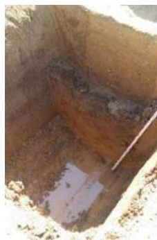
Photo 1 : Exemple de réalisation d'un sondage géomorphologique
