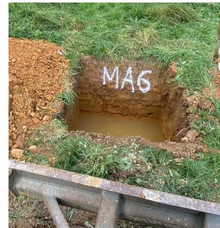
Photo 9 : Mesure du temps d'infiltration
