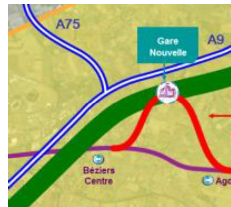
Figure 36 : Gare nouvelle en ligne + déviation ligne classique
