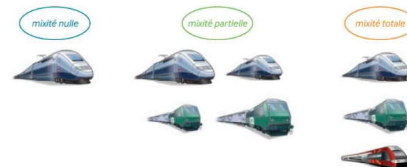
Figure 13 : Les différents degrés de mixité d'une voie ferrée
