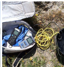
Photo 21 : Sondes multiparamètres utilisées pour mesurer les paramètres in-situ
