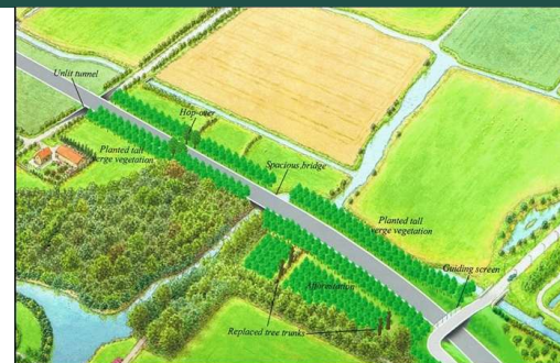
Figure 22 : Passage d'une chauve-souris par un Hop-over (image du haut) et exemples d'installations favorables aux chiroptères lors de la construction d'une route (Source : LIMPENS et al., 2005)
