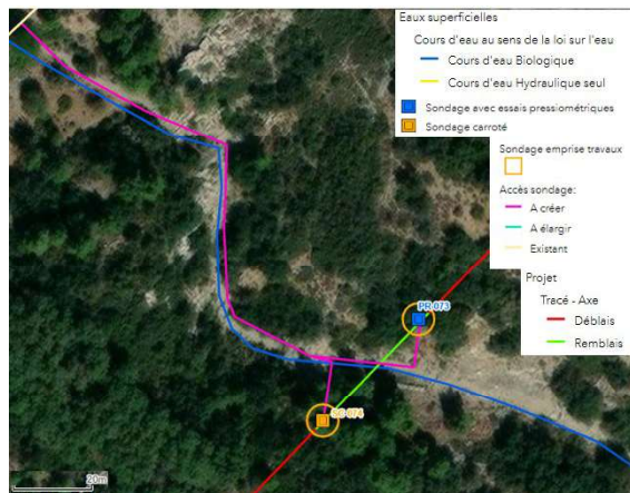
Figure 22 : Passage à gué pour l'accès au sondage SC074
