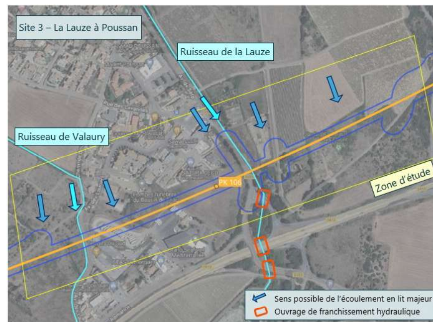
Figure 18 : Sens possible d'écoulement en lit majeur des ruisseaux de la Lauze et de Valaury
