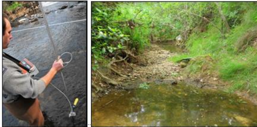
Photographie 4 : Mesure du débit à l'aide d'un micro moulinet électromagnétique (source : ASCONIT Consultants)
