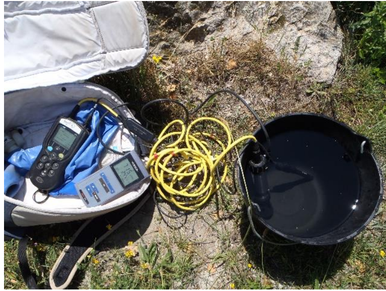
-Photographie 13 : sondes multiparamètres utilisées pour mesurer les paramètres in-situ
