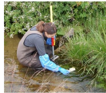
Photographie 15 : prélèvement de macro-invertébrés benthiques en cours d'eau
