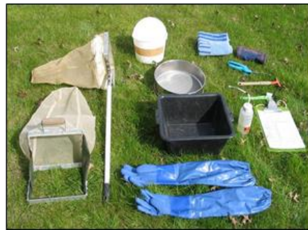
Photographie 14 : matériel de prélèvement de macro-invertébrés benthiques
